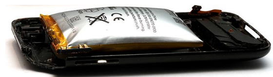
Vid skada på cellen och överhettning sväller cellen.
